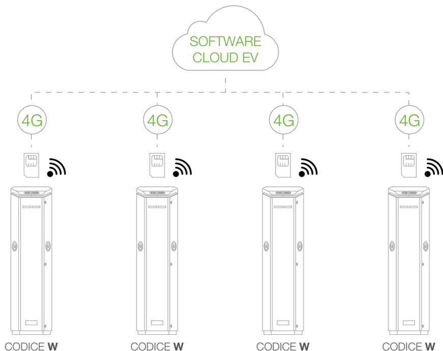
Le stazioni di ricarica sono tutte equipaggiate di Kit Router 4G (versione «W») e comunicano «Peer To Peer» con il backend di comunicazione tramite protocollo OCPP 1.6 JSON.
