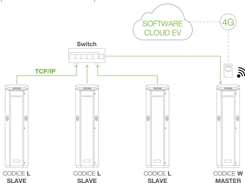
Le stazioni di ricarica sono tutte equipaggiate di Kit Ethernet (versione «L») sono cablate a centro stella all'interno di uno Switch. I dati vengono poi trasferiti alla stazione MASTER che integra un Router e la SIM Vengono cablate entra esci con linea TCP/IP e solo l'ultima stazione di ricarica ha una SIM che comunica 4G con il backend tramite protocollo OCPP 1.6 JSON.
